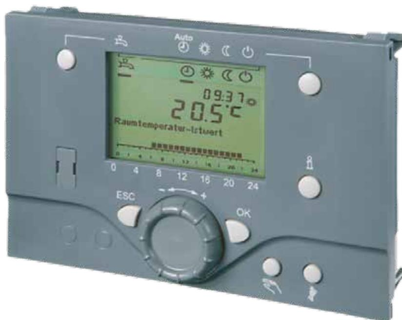
Панели управления котлом RVS, применяемые в системе котла, могут быть выбраны в соответствии с модульной структурой. Панель управления котлом в зависимости от наружной температуры регулирует температуру воды на выходе из котла и управляет 3-ходовым поворотным клапаном и насосами. Каскадная система опционально позволяет нескольким котлам работать как один котел (до 15 газовых котлов MIT).
